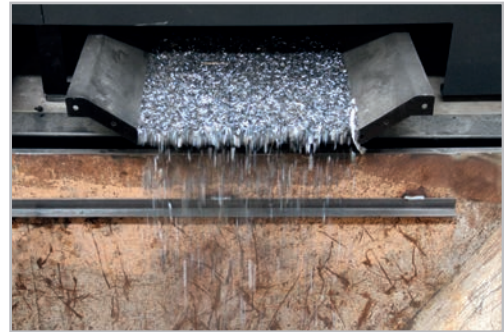
Chip automatic extraction Extracción automática de viruta
