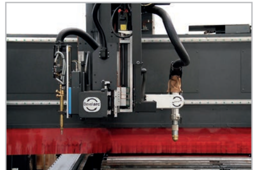
Plasma and Oxyfuel in a single head Plasma y Oxicorte en un mismo cabezal
