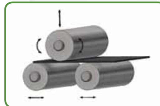
Rolls movement scheme / Abbildung Walzenverstellungen / Схема движения валков
