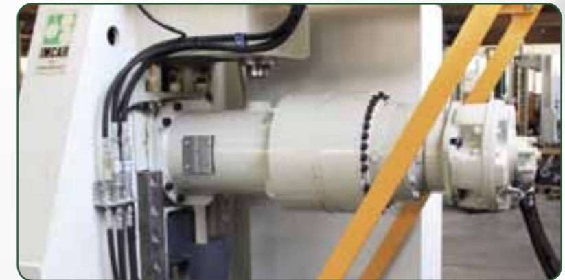
Interchangeable quick-release system for the top roll / Schnellwechseleinrichtung für Oberwalze / Система быстрой замены верхнего валка
