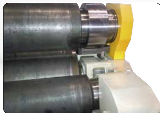
Cone rolling device (standard for 4R series) Konischbiegeeinrichtung (Standard für 4R Serien) Устройство для гибки конусов (в стандарте для 4R серии)
