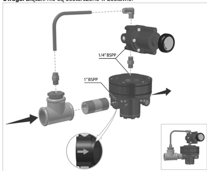
3-drogowy zawór kulowy należy zamontować do przyłącza wylotu azotu w położeniu pionowym zapewniającym swobodny dostęp do przyłącza środkowego w celu podłączenia przepływomierza.
