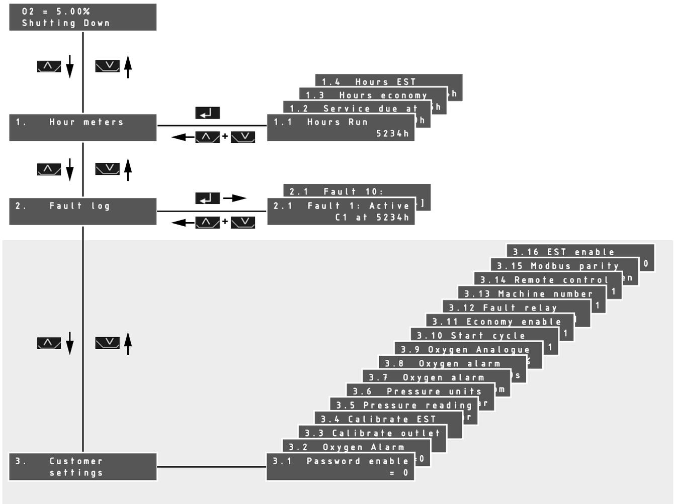
Par défaut, l'interface revient automatiquement au menu principal de fonctionnement si aucune touche n'est activée pendant une minute.
