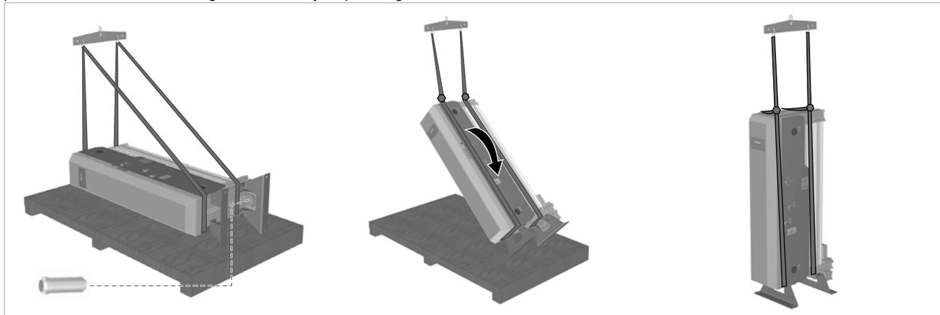
Retire los cuatro bloques de madera de detrás de la carcasa.
