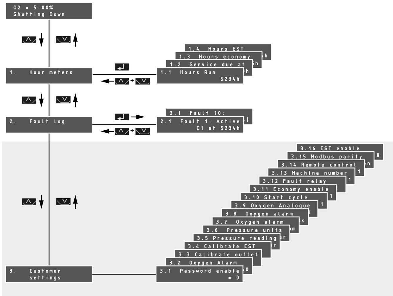
La interfaz volverá automáticamente, por defecto, al menú de funcionamiento principal si no se ha activado ninguna tecla durante un minuto.
