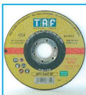
Sono indicate per il taglio di acciai di piccole e medie sezioni. Grazie al loro ridottissimo spessore hanno un taglio estremamente veloce e preciso, senza formazione di bave. Non riscaldano il pezzo lavorato. Gli articoli MT9, MT10 e MT16 sono esenti da composti di ferro, zolfo e cloro e sono indicati nei settori chimico, alimentare e nucleare.
