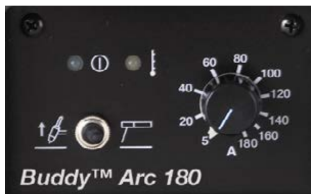
Апаратите Buddy™ Arc 180 се настройват с едно копче за регулиране на заваръчния ток и един превключвател за избор между РЕДЗ и ВИГ заваряване с LiveTIG запалване на дъгата.
