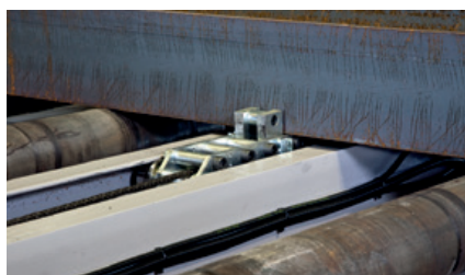
Ripeur de chargement à doigt escamotable Loading chain with retractable finger Kettenförderer mit einziehbarer Nocke
