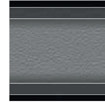
BAR-покритие нитрирана стомана Преходен слой През закалената инструментална стомана до специалната сплав Siegmund X8.8 Преходен слой нитрирана стомана BAR-покритие
