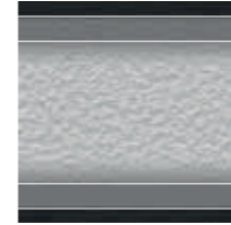
BAR-покритие нитрирана стомана Преходен слой Премиум стомана S355J2+N Преходен слой нитрирана стомана BAR-покритие
