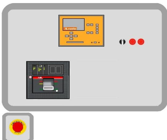
**Centralina di controllo LOVATO ELECTRIC RGK800 con multimetro (voltmetro, amperometro, frequenzimetro, contaore e voltmetro batteria). Funzione test periodico e funzione di monitoraggio della tensione di rete. Indicazione della percentuale di carburante residua. Display LCD retroilluminato. Centralina espandibile con moduli di comunicazione dedicati e moduli di espansione per incrementare la funzionalità.**
