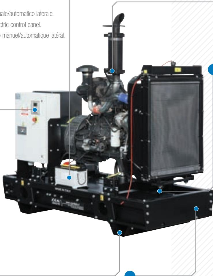
**IT** Basamento per gruppo elettrogeno aperto, realizzato in acciaio strutturale. Quattro zampe di appoggio con fori per il fissaggio al suolo della macchina. Supporti antivibranti in gomma tra motore/alternatore e basamento.
