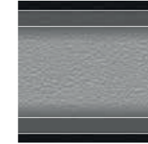
BAR-покритие нитрирана стомана Преходен слой През закалената инструментална стомана до специалната сплав Siegmund X8.7 Преходен слой нитрирана стомана BAR-покритие
