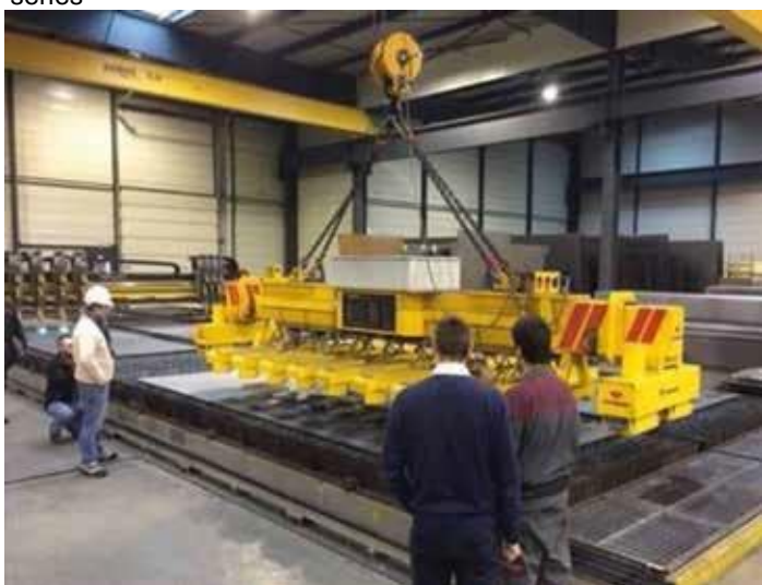
Серия COMBI за товарене/разтоварване на материал за машини за рязане в рамките на една операция (плазма, лазер...)
