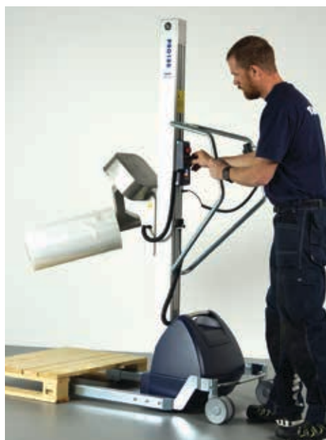
Захват през шпурата / по вътрешен диаметър
